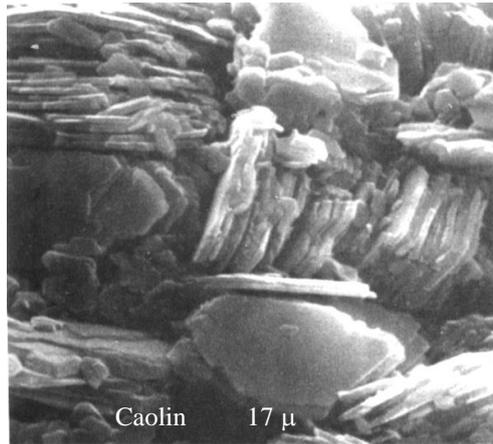
**Figura 1.9:** Fotografía bajo el microscopio electrónico, de una muestra de caolín
