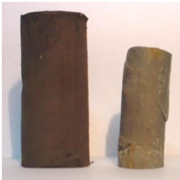
**Figura 1.39:** Disminución de volumen por contracción debido al secado de una probeta de arcilla expuesta al medio ambiente
