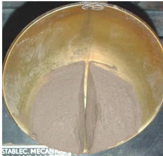
**Figura 1.18:** Estado final de la muestra en el Cascador de Casagrande para determinar la humedad del límite líquido
