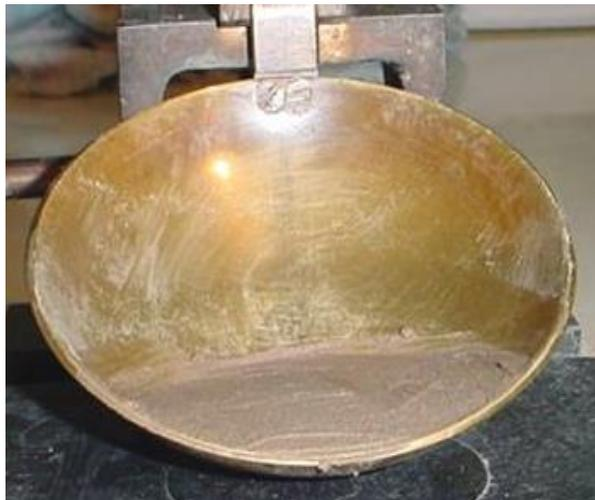
**Figura 1.16:** Colocación de la muestra en el cascador de Casagrande
