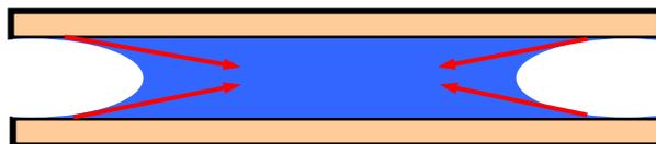
**Figura 1.38:** Fuerza que genera la tensión superficial del agua en los capilares formados entre partículas de arcilla
