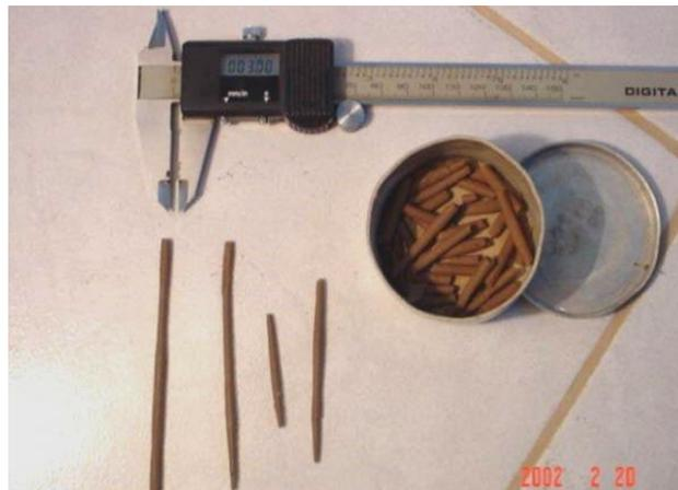
**Figura 1.20:** Determinación del límite plástico
