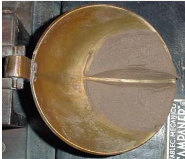
**Figura 1.17:** Ranura en la muestra en el cascador de Casagrande
